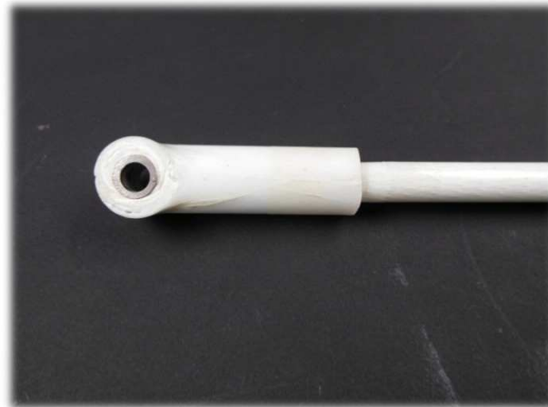
Tenon en PA-6 renforcé à 35% vol. en fibre de verre continue + insert métallique
