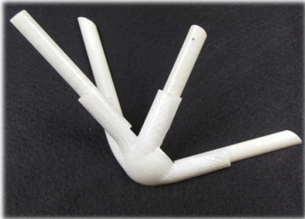
Nœud de liaison PA 6 renforcé à 35% vol. en fibre de verre continue
